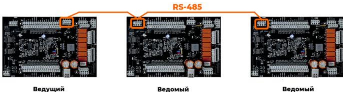
Рисунок 2. Пример подключения ведомых АС-С8 к ведущему АС-С8.
